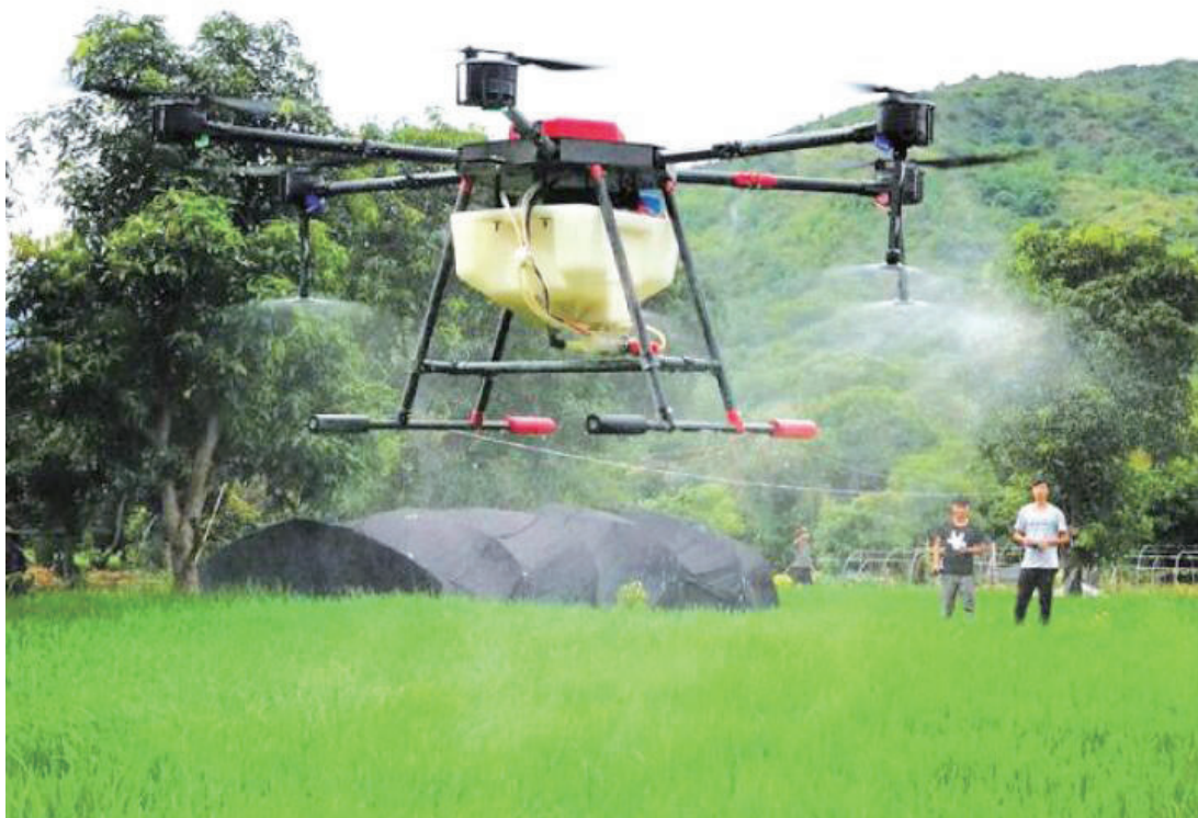
6月26日,潜山市梅城镇乡情农机合作社社员正用植保无人机给水稻施药。眼下正是水稻病虫害防治关键时期,采用植保无人机智能模式作业,设定好参数和路径均匀精准喷洒药剂,农药利用率高,防治效果好;农药对环境的污染小,确保农业丰产和环境保护两不误。
